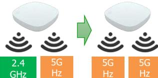
すべてのクライアントの通信を5GHzで利用することで安定した通信品質を提供
